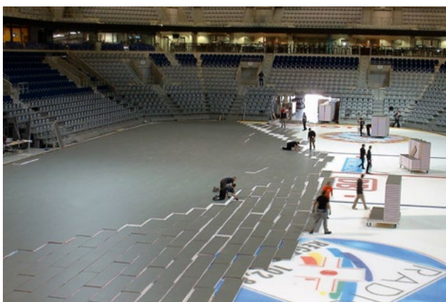
Mit dem Speed-Lock Ice Cover System verwandeln Sie eine Eissportarena in kürzester Zeit in eine Multifunktionsarena.
