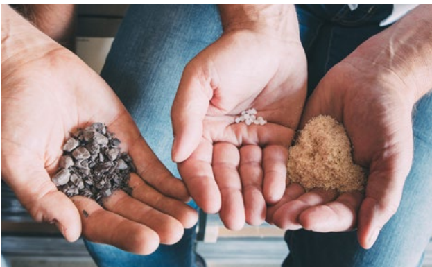
GCC (German Compact Composite) Holzwerkstoff besteht aus bis zu 75 % Naturfasern, veredelt mit 25 % Polymeren und Additiven
